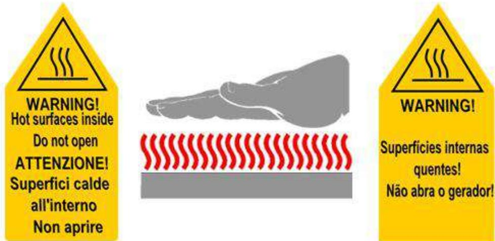
Tenha cuidado ao manusear o gerador no caso de manutenção ou outro tipo de contato. Este equipamento dispõe de um sistema interno de aquecimento com partes de metal (bloco de aço, ferro fundido e alumínio), e este produto não deve ser aberto nem manipulado no período de 24h após o seu desligamento.
